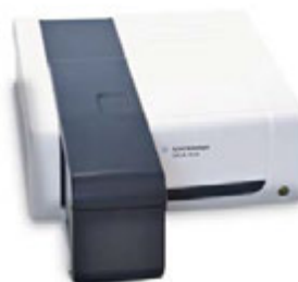
Увеличенный отсек для пробы, установленный в Agilent Cary 60 UV-Vis
